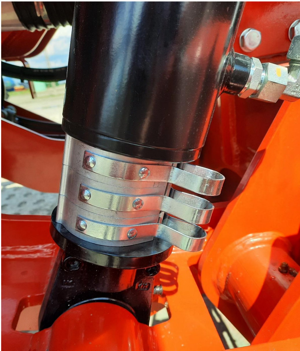
Abb. 65. Sicherheitsclips an den Zylindern
