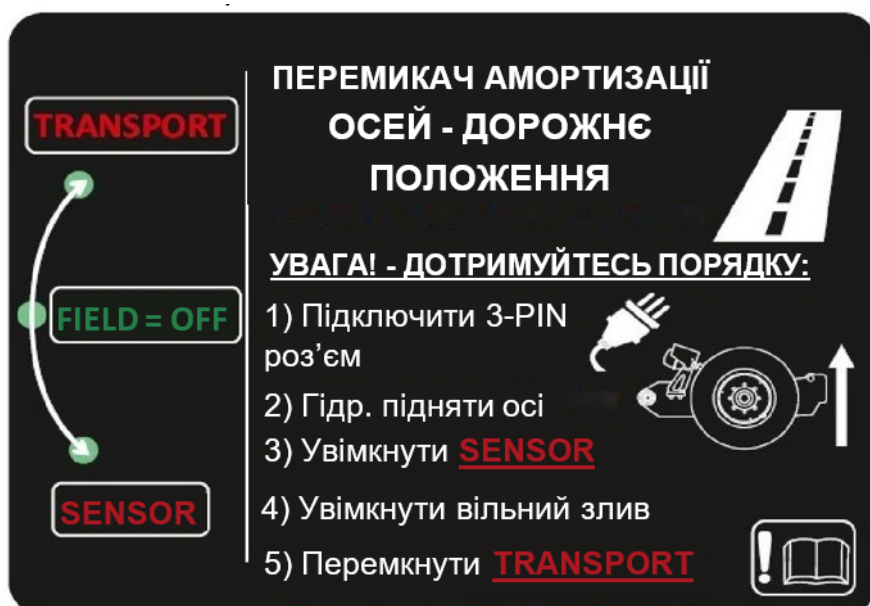
Мал. 93 Інструкція перемикача амортизації осей у транспортне положення
