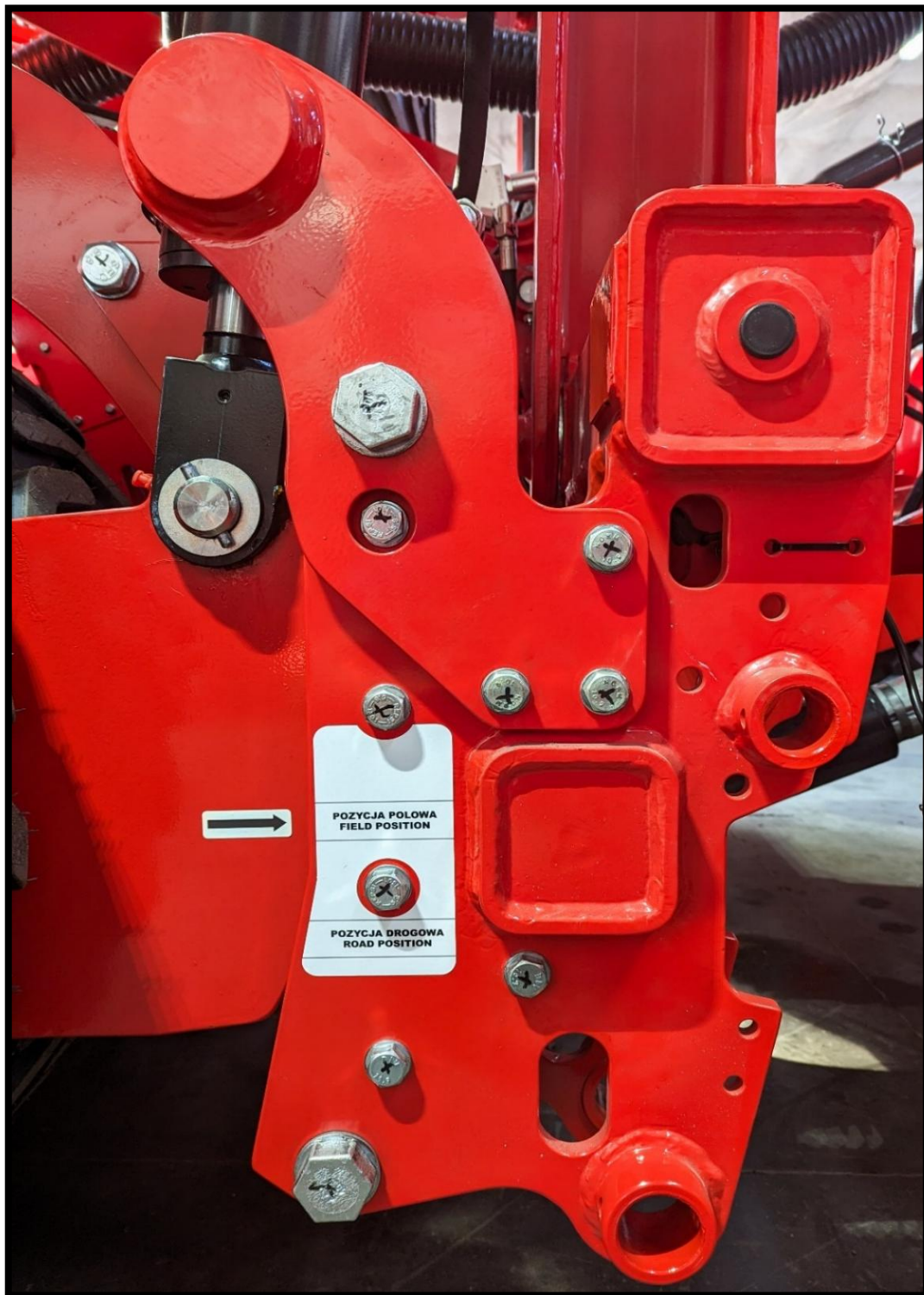
Мал. 53 Амортизація осей в польовому положенні
