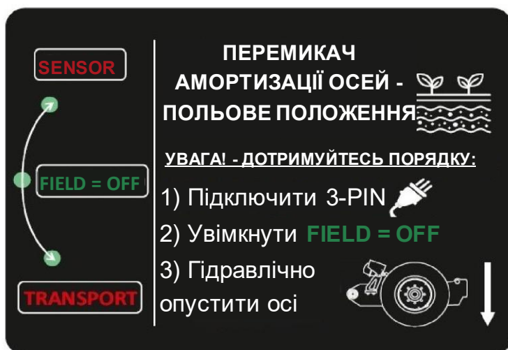
Мал. 52 Блок керування амортизацією - польове положення
