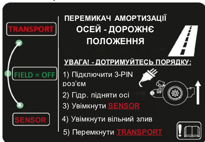
Мал. 51 Блок керування амортизацією - дорожнє положення
