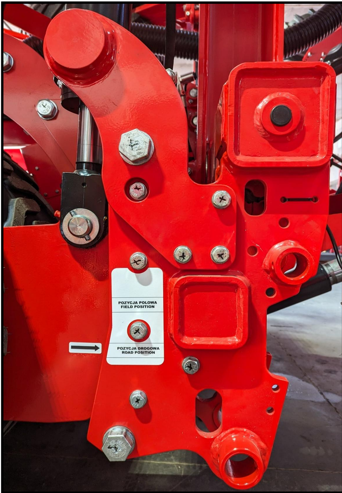
Мал. 54 Амортизація осей в дорожньому положенні
