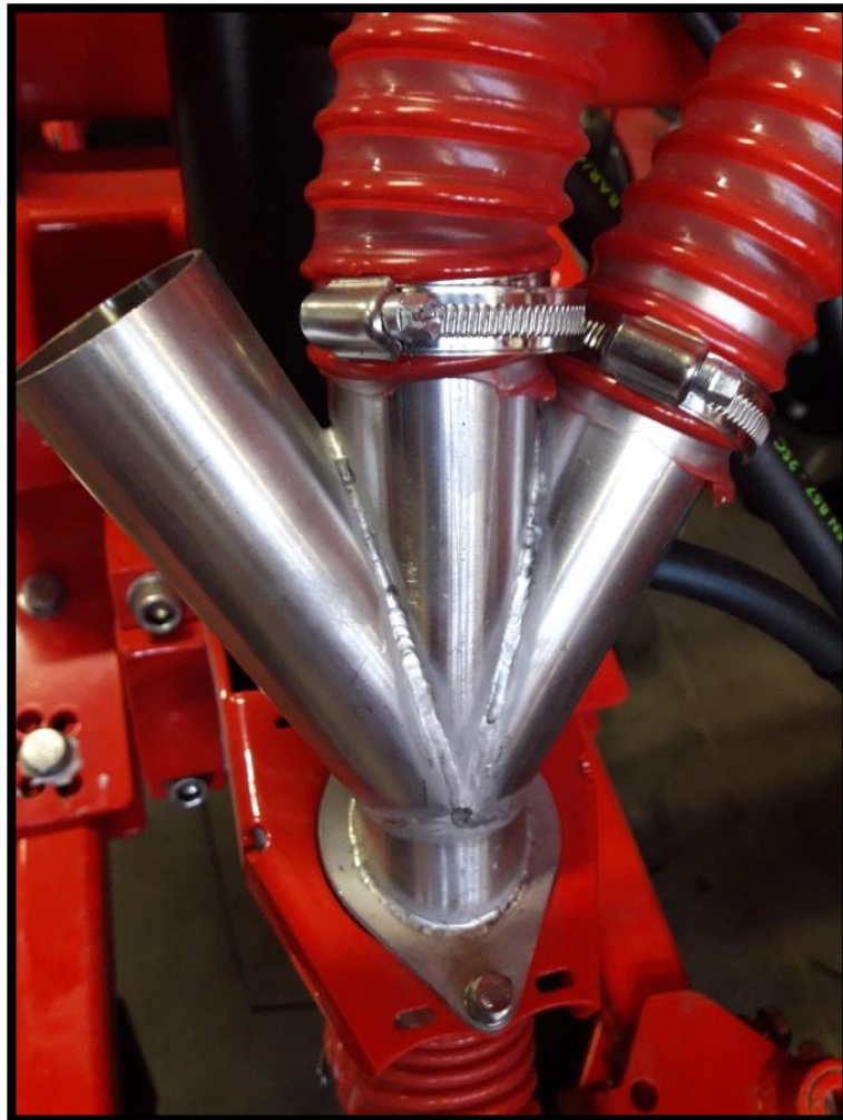
Мал. 67 Приєднання шлангів для добрив до розподільника робочої секції
