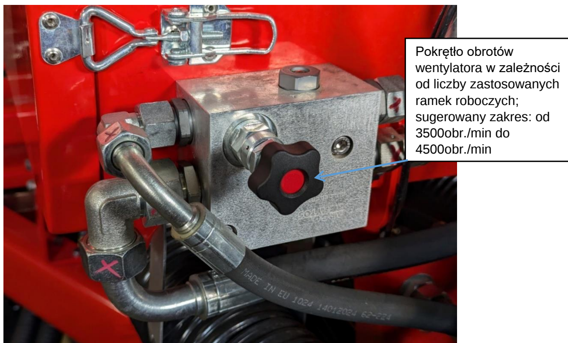
Rys. 42. Układ regulacji prędkości wentylatora oraz wentylatora lub WOM maszyny zaczepianej.
